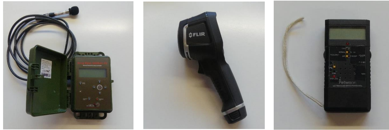
Enregistreur SM4BAT FS (gauche), caméra thermique FLIR (centre) et détecteur d'ultrasons Petterson D240X (droite)
